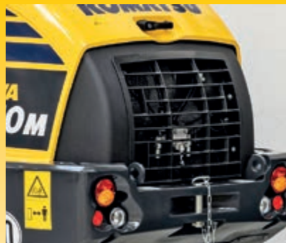
Grobmaschiger Kühler mit automatischem Umkehrlüfter (optional)
