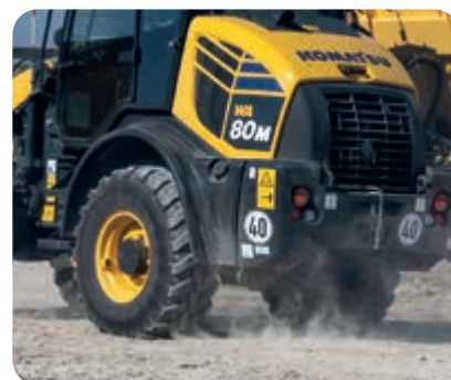
Schnellläuferversion mit 40 km/h hydrostatischem Antrieb (optional)
