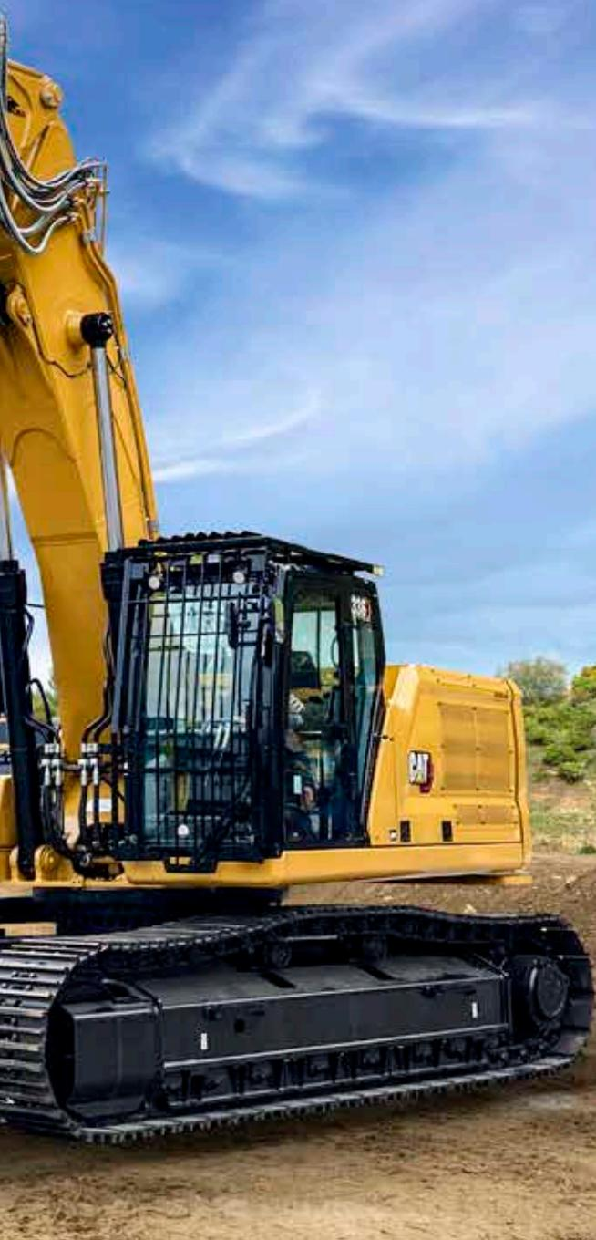
Durch die hydraulischen Verstellausleger gewinnen der 336 und 340 deutlich an Flexibilität und Leistungsfähigkeit und sind bestens geeignet für Kanalbau, Abbruch und das Arbeiten in beengten Verhältnissen. Durch den Nackenzylinder ist die VAH-Ausrüstung die perfekte Wahl für den Kanalbau.
